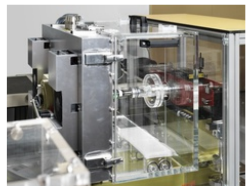
Sonderbau Memmert Klimaschrank in der Drehmoment-Normalmesseinrichtung
