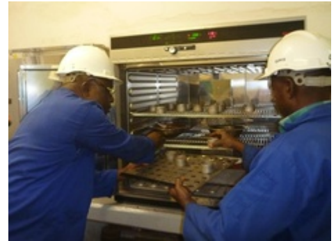
Memmert Universalschrank U für die Baustoffprüfung
