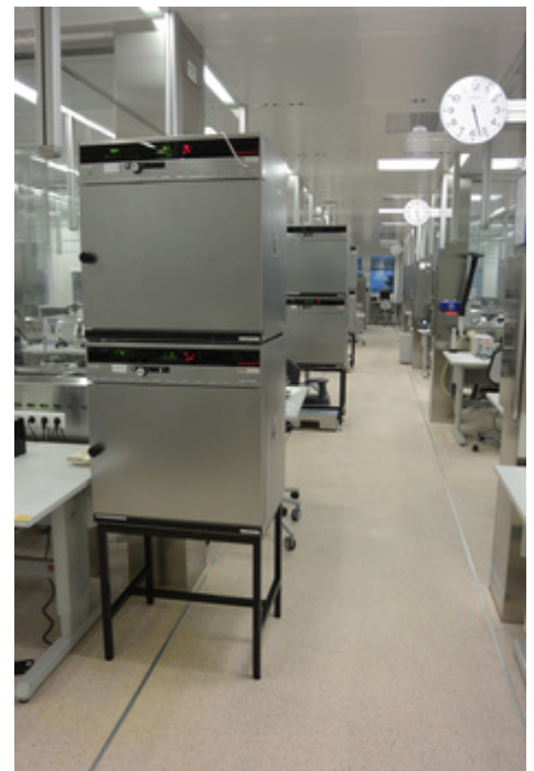
MED-EL härtet Kleber und Silikon im Memmert Trockenschrank aus
