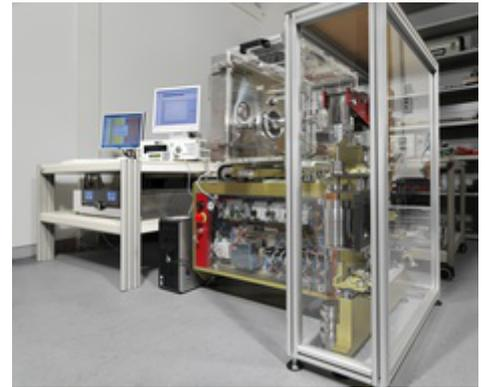
Standard torque measuring instrument at the *Physikalisch-Technische Bundesanstalt*
