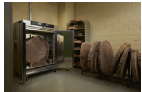
Memmert Trockenschrank UF750plus für Dichtebestimmung von Holz
