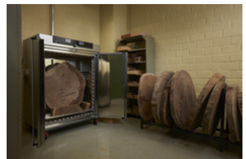
Memmert Trockenschrank UF750plus für Dichtebestimmung von Holz
